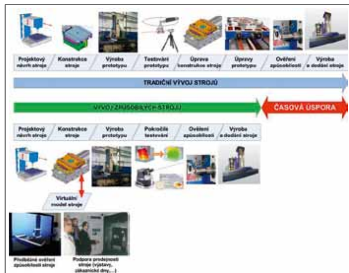
Obr. 1: Srovnání tradičního vývoje strojů a vývoje způsobilých strojů s využitím technologie imerzivní virtuální reality a pokročilého testování pomocí LaserTraceru ETALON
