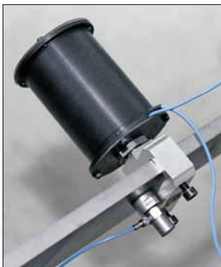
Malý aktivní dynamický tlumič vyvinutý na pracovišti (lze využít např. k potlačování vibrací obrobků)
