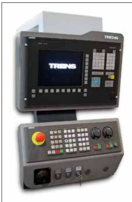
Obr. 5: Pro stroje TRENS je navržen rovněž nový ovládací panel s modulární koncepcí.
