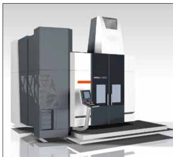
Obr. 9: Charakteristické tvarové prvky navržené na krytování stroje Multicut 630 byly uplatněny i na krytování přetlakového centra MCU 1100.
