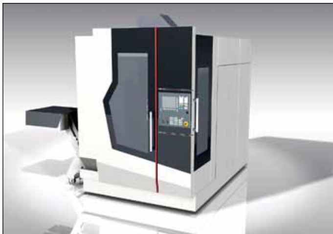
Obr. 10: Pro HESTEGO byly připraveny návrhy krytování vertikálních frézek s využitím velkoplošného lepeného zasklení.
