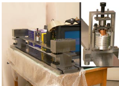
Obr. 3: Testovací stand STD-29 pro výzkum aktivního potlačování vibrací
