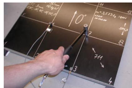
Obr. 4 Modální analýza sendviče s laminátovým potahem vyztuženým uhlíkovými vlákny a s jádrem tvořeným hliníkovou pěnou
