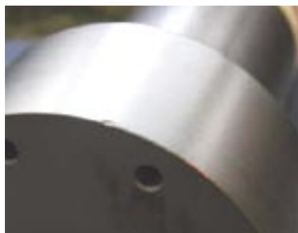
Obr. 1 Keramický náhonový hřídel dle návrhu VCSVTT (DxL cca 150mm x 400mm)
