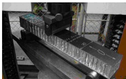
Obr. 2 Měření na sendviči s voštinovým jádrem a laminátovým potahem vyztuženým uhlíkovými vlákny
