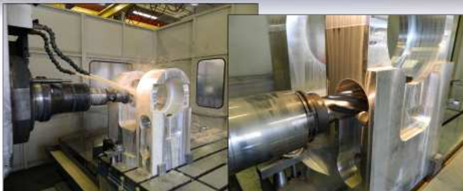
Frézování hliníkového tělesa frézovací hlavy HV/2
