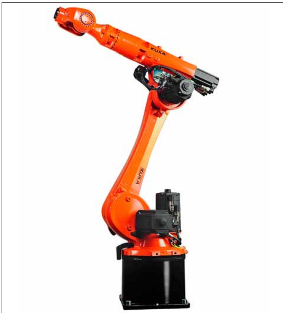
Rameno najnovšieho modelu – robota KUKA KR20 je vybavené reduktormi TwinSpin z prešovskej spoločnosti SPINEA.
