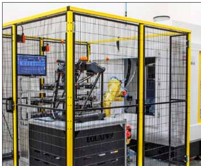
Robotická obráběcí buňka Renishaw.
