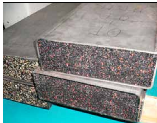
Obr. 3: Alternativní konstrukce smykadla s výplní MDM.
