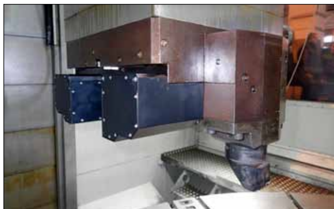
Obr 2: Soustružnický adaptér s integrovaným hltičem na karuseli firmy TOSHULIN, a.s.
