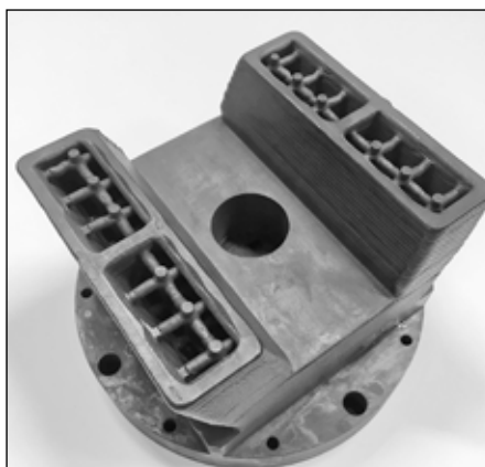
Tenkostěnný dutý dílec s vnitřní podpůrnou strukturou, ve střední části je rovina založena „ve vzduchu“ na podpůrné struktuře; konstrukční ocel, hmotnost návaru 3,9 kg, rychlost výroby 0,22 kg/h.
