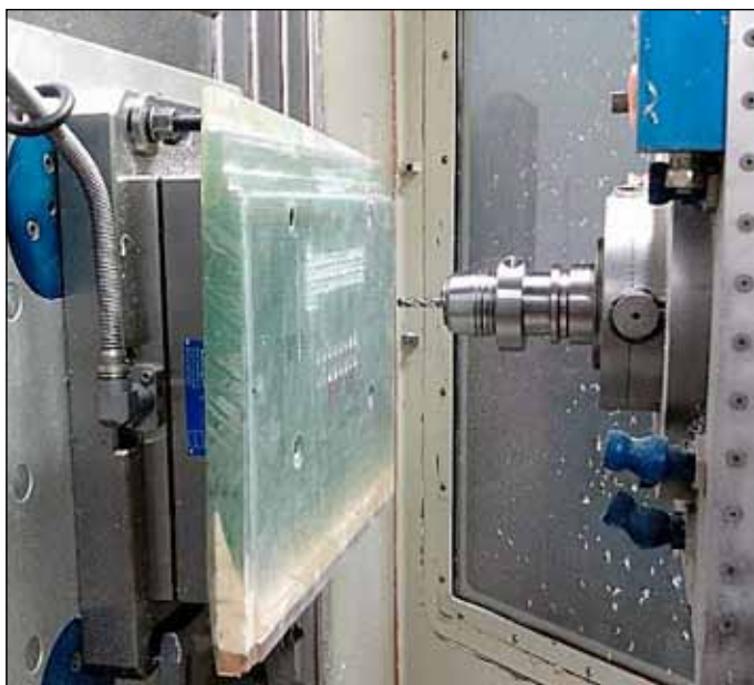
Obr. 2: Experiment měření řezných sil při vrtání termosetického kompozitu
