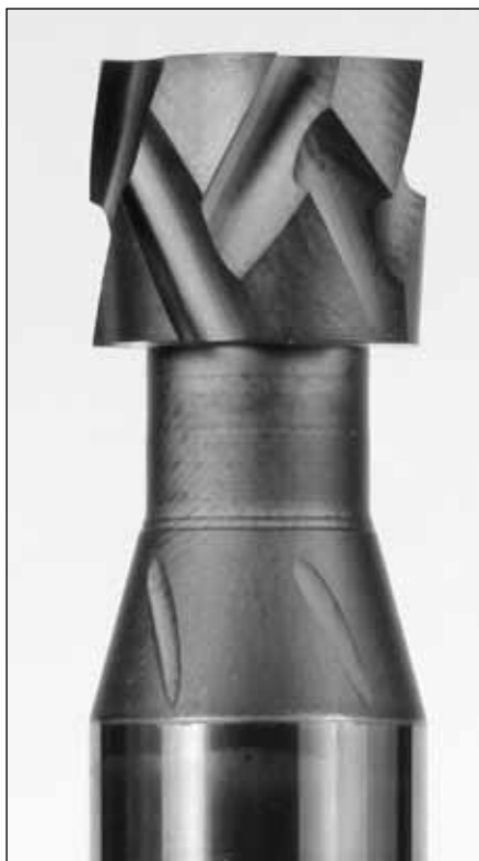
Obr. 4: Vyvinuté prototypy řezných nástrojů s břitě ze slinutého karbidu (vlevo) a diamantu (vpravo) pro frézování kompozitů s termoplastickými maticemi
