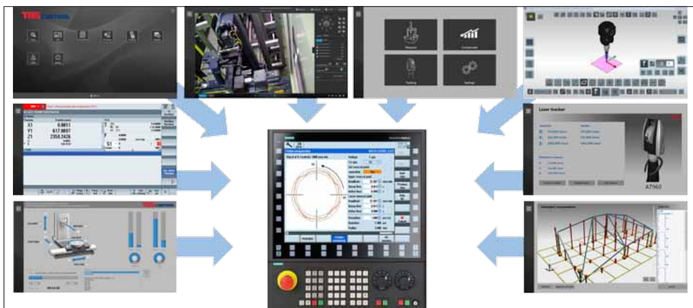
Nadstavbové prostředí TOS control integruje řadu aplikací pro podporu provozu a monitorování stavu stroje
