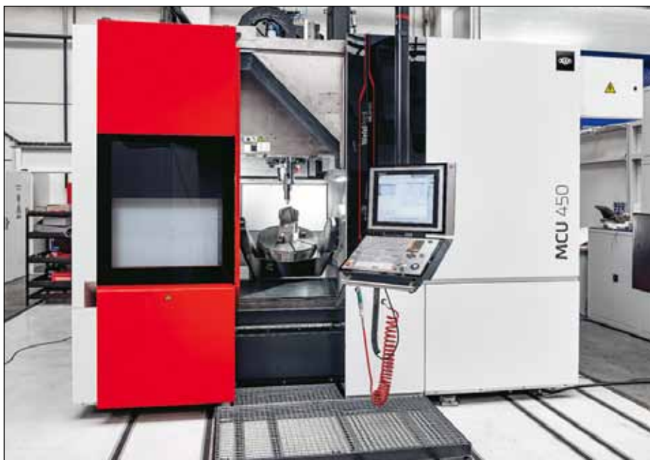
Stroj WeldPrint MCU 450V-5X, který umožňuje pětiosé obrábění i navařování, přičemž změna technologie obrábění a navařování netrvá ani dvě sekundy. (Zdroj: Kovosvit MAS)
