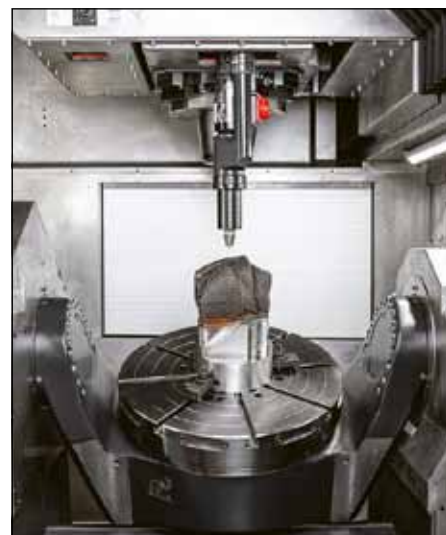
Stroj WeldPrint MCU 450V-5X, který umožňuje pětiosé obrábění i navařování, přičemž změna technologie obrábění a navařování netrvá ani dvě sekundy. (Zdroj: Kovosvit MAS)
