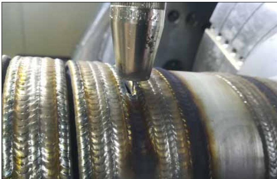
Detail tvorby přemostění chladicího kanálu. (Zdroj: RCMT)
