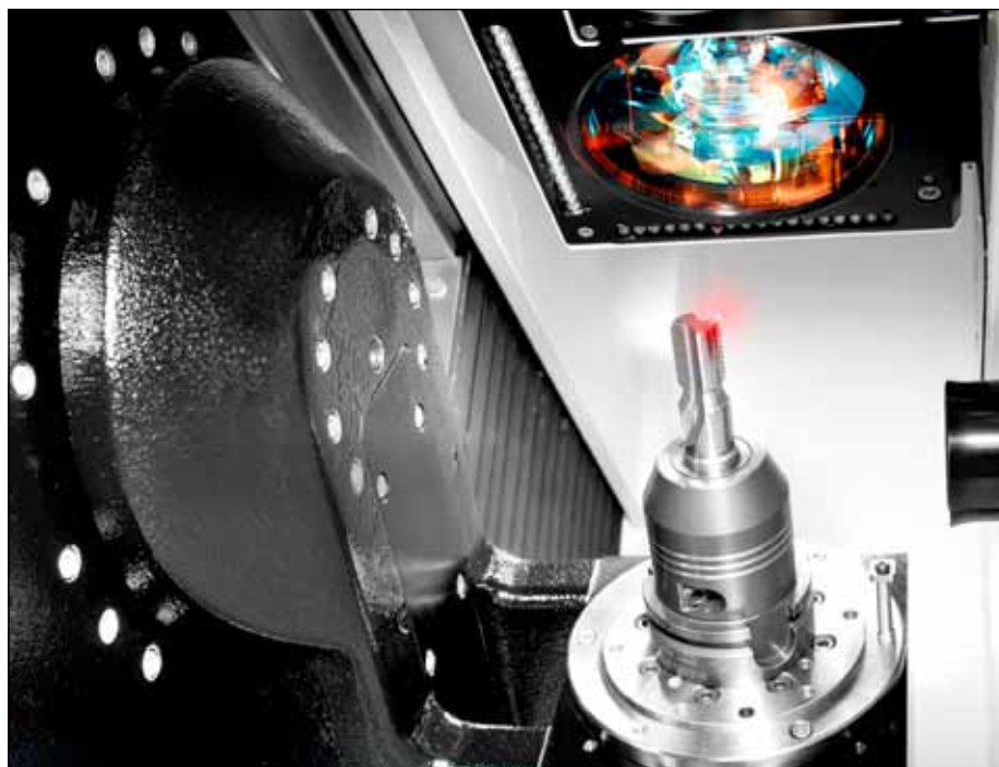
Výroba PKD nástroje laserem. (Zdroj: Rotana)
