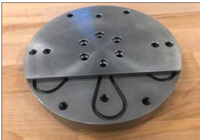
Chladicí kanály aplikované v upínacím stole. Stůl je součástí pětiosého navařovacího pracoviště a je teplotně stabilizován. (Zdroj: RCMT)
