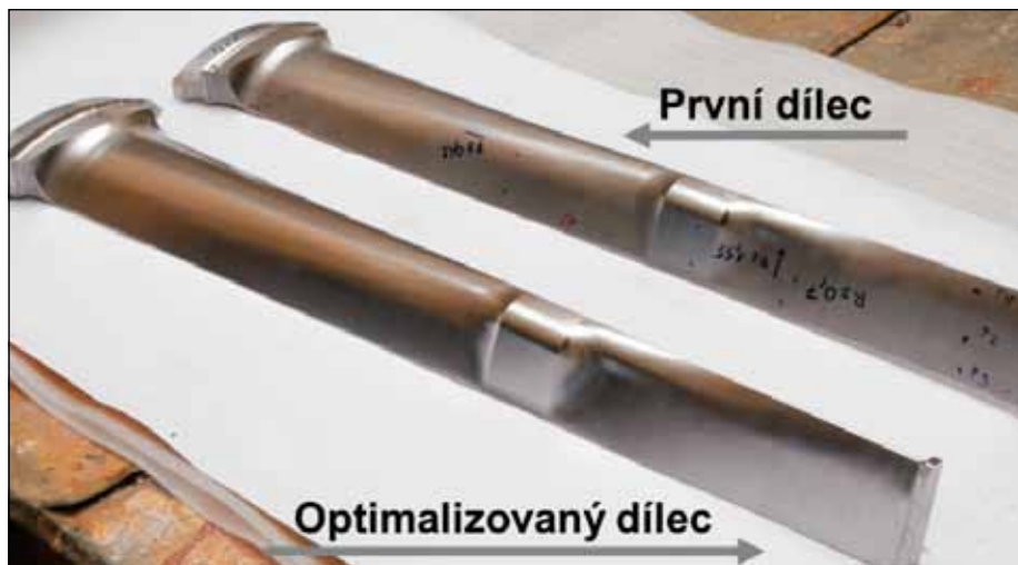
Uplatnění plného digitální dvojčete stroje a procesu vedlo k úspěšné eliminaci řady výrobních chyb na štíhlé tenké lopatce
