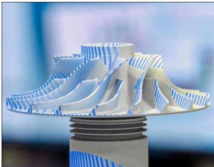
Skenovanie mikroturbíny prúdového motora z niklovej zliatiny
