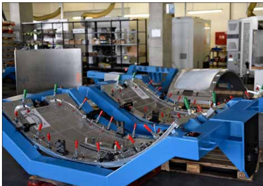
Výrobný prípravok pre dvere lietadla Embraer
