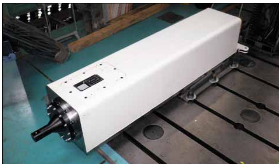
Vzorek smykadla hybridní materiálové koncepce se zvýšeným tlumením
