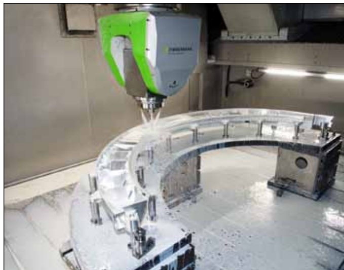
5D obrábanie držiaku motora
