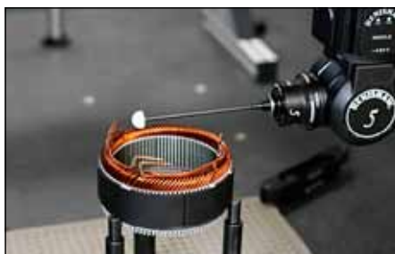
REVO vysokorychlostní kontrola statorů
