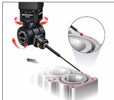
Skenování roviny systémem REVO – gasket scan
