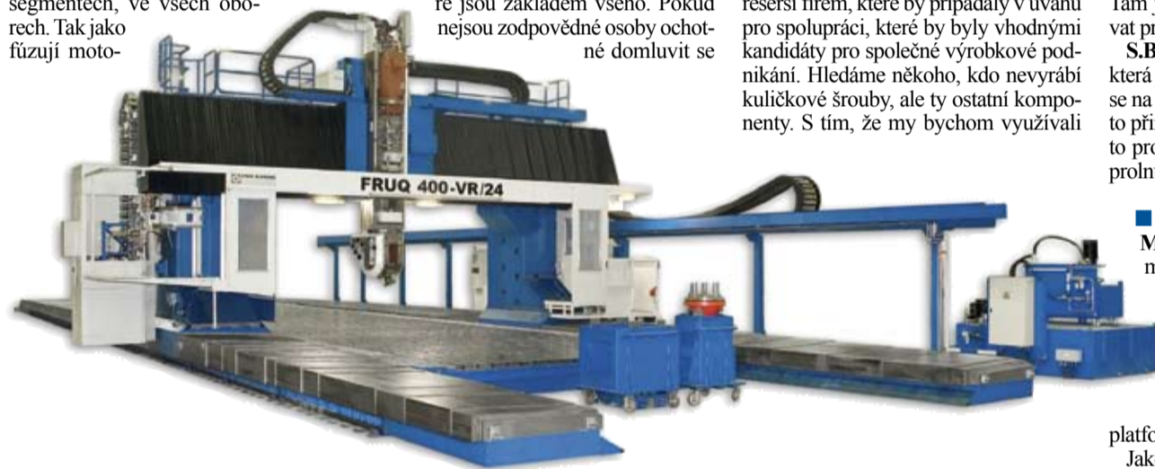
Portálové obráběcí centrum řady FRU je určeno pro velmi přesné obrábění těžkých, rozměrově a tvarově velmi složitých obrobků až z pěti stran klasickou technologií i rychlostním obráběním. Provedení s posuvným portálem po samostatných ložích umožňuje jednoduše řešit požadavky na rozdělení pracovních prostorů pro současně obrábění a upínání obrobku. Stroj je možné vybavit automaticky výměnnými vřetenovými hlavami o výkonu až 60 kW. Průchodnost mezi stojany může být až 5300 mm. Základní vzdálenost mezi upínací plochou stolu a přestavitelným příčnickem je 2200 mm
