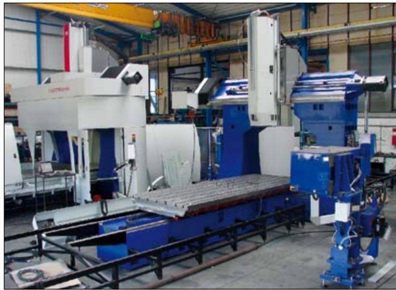
Montáž strojů FVC 120 CNC. Frézovací a vrtací centrum modelové řady FVC je typickým představitelem tuhé portálové konstrukce s pojízdným stolem. Tento stroj našel uplatnění v širokém spektru technologických operací, kterými jsou například výroba forem, hrubování a dokončování výrobků z nejrůznějších materiálů. U specifikace se zvýšenou přesností také jako velmi přesný stroj pro dokončování rovinných i tvarových ploch
