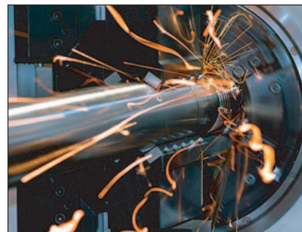
Detail okružování polotovarů kuličkových šroubů
