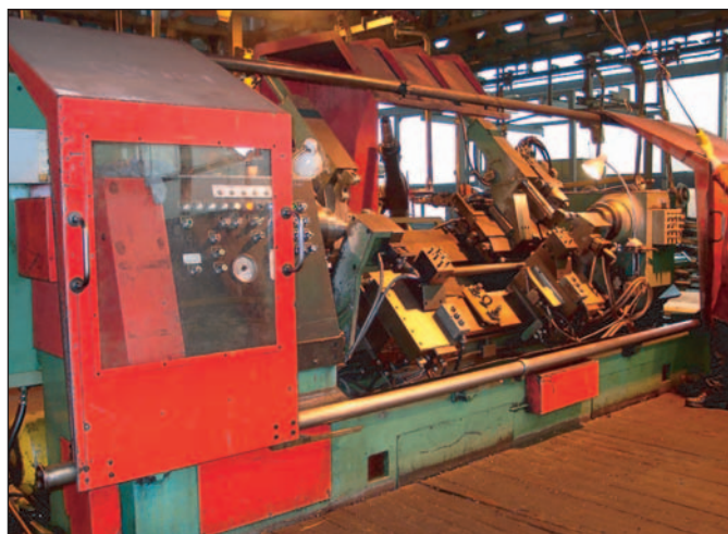
Původní jednoúčelový stroj pracující v maďarské společnosti RÁBA Győr byl nahrazen univerzálním soustružnickým centrem značky MAS.
