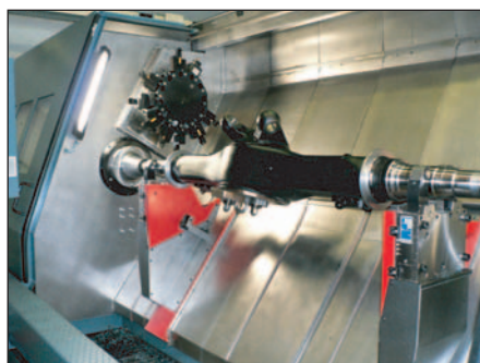
Soustružnické centrum SPH 50 DS kompletně opracovává konce náprav (na jedno upnutí) včetně oboustranného závitování a frézování drážek pro pero.
