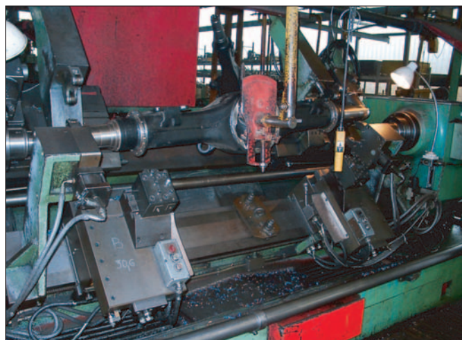
Původní jednoúčelový stroj pracující v maďarské společnosti RÁBA Győr byl nahrazen univerzálním soustružnickým centrem značky MAS.
