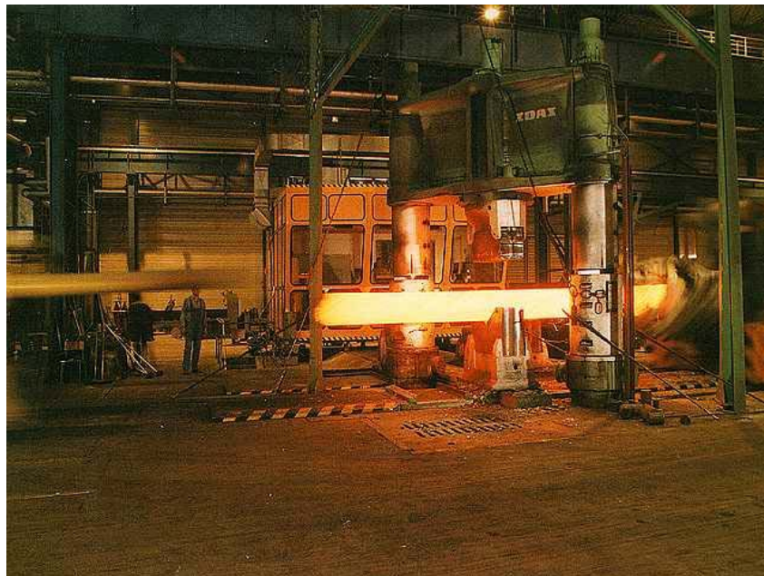
Obr. 1-9 ŽŽAS, a.s. - Kování dlouhé hřídele na kovacím lisu CKW
