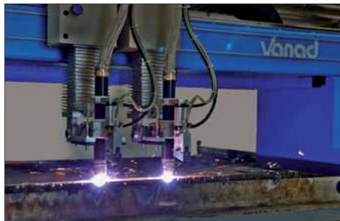
Simultánní řez dvěma plazmami
