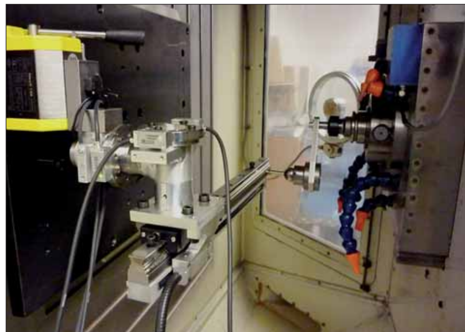
Obr.1 - Dvoudílné měřicí zařízení pro měření chyb v pracovním prostoru strojů
