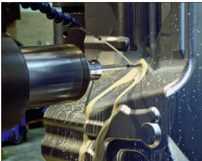
Obrábění tvarových ploch na horizontální vyvrtávačce
