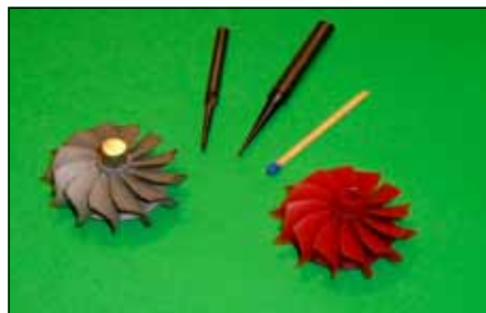
Obr. 19: Při obrábění mikrofrézováním jsou používány nástroje o \varnothing \leq 1 . mm
