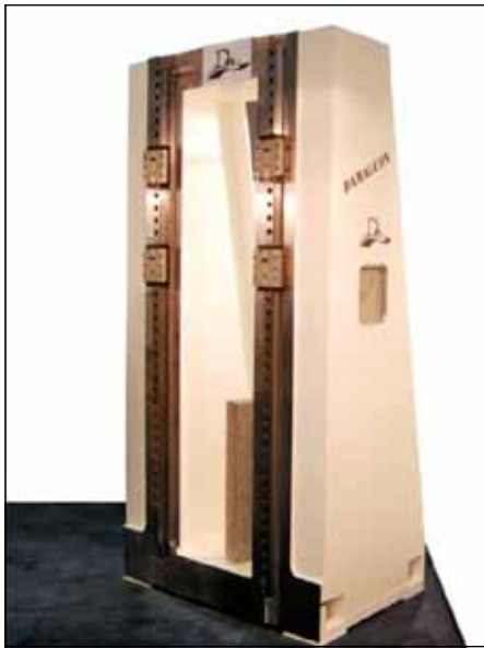
Obr. 12: Hybridní stojan sendvičové konstrukce
