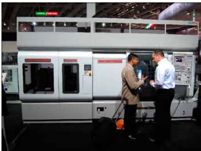
Mori Seki: soustružnické centrum s integrovaným zakladačem, měřicími stanicemi a zásobníkem obrobků
