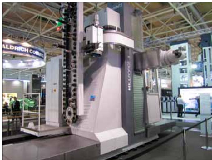
Stojan s rozšířenou základnou firmy Union Chemnitz
