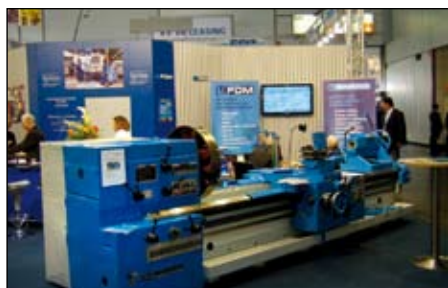
Generálkovaný univerzální soustruh SUS 80/2750 r.v. 1975, z produkce TOS Čelákovice na stánku německého prodejce použitých obráběcích strojů
