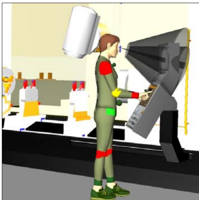
Obr. 2: Ergonomická analýza rozmístění ovládacích prvků výrobního stroje
