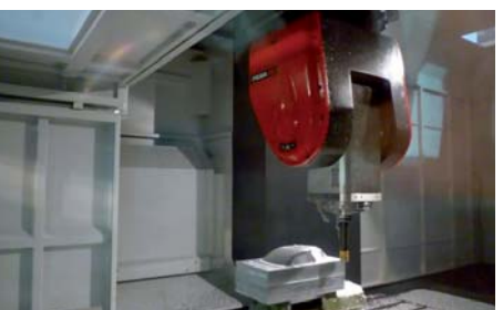
Stroje S5A-3220 společnosti FFG-Sanco využívají kompletní dodávky osy Z, C, A a vřetena od firmy Fidia a nijak se tím netají, jak znázorňuje pohled do pracovního prostoru stroje.
