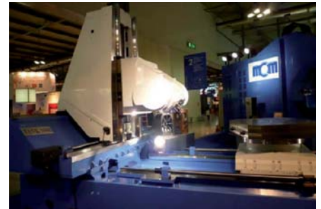
Stroj TANK 1900 od společnosti MCM s oboustranným náhonem kuličkového šroubu osy X (pojezd stojanu do strany).
