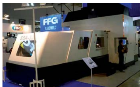
Stroje S5A-3220 společnosti FFG-Sanco využívají kompletní dodávky osy Z, C, A a vřetena od firmy Fidia a nijak se tím netají, jak znázorňuje pohled do pracovního prostoru stroje.
