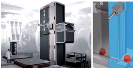
Největší stroje Parpas užívají náhon osy X typu master-slave s ozubeným hřebem a pastorky. Zajímavé je však přímý náhon pastorku prstencovým motorem.
