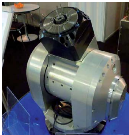
Celoduralová hlava Cytec řady CyMill, serie S8, 26 kW, 42 Nm, 20\,000\text{ min}^{-1} a pouze 180 kg.
