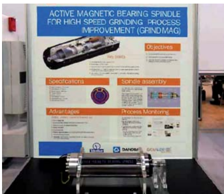
Španělská společnost Danobat představila elektrovřeteno uložené na magnetických ložiskách. Maximální otáčky jsou 72 000 min -1 a výkon 5,5 kW.
