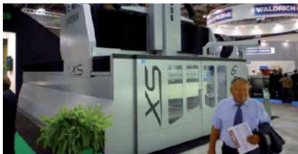
U přesných strojů Parpas je každý nosný dílec opláštěn krytem s mezerou 50–80 mm a prostor je klimatizován, i u pohyblivých dílců, dílce jsou ve stále teplotě.
