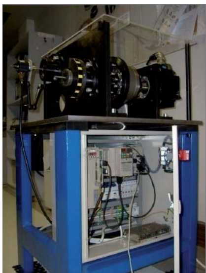
Obr. 3. Elektroskříň a servomotor
