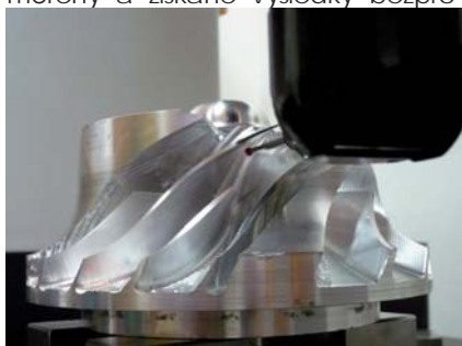
Obr. 5. Měření přesnosti dosaženého tvaru lopatky na měřicím stroji
