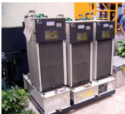
Obr. 19. Stále častější pohled na rozšiřující se systémy chlazení strojů s oddělenými okruhy chladicího média pro jednotlivé účely chlazení. Toto jsou chladicí agregáty horizontálního centra MAKINO MAG-1.
