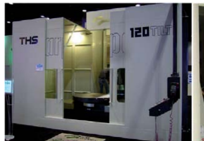
Obr. 7. Větší horizontální centrum pro komplexní pětiosé obrábění od firmy Parpas nazvané THS-X-Tilt Aero Machine. Rozjezdy v osách X, Y, Z jsou 2 m; 1,6 m; 1,6 m, otočný stůl má průměr 1 600 mm a je poháněn prstencovým motorem. Stroj má pohyblivý stojan vytvořený jako ocelový svařenec s výrazným skosením ve směru pohybu Z osy (vpravo). Stroj byl na několika rozměrných dílcích leteckých motorů prezentován jako ideální právě pro leteckou výrobu (obdobně jako menší stroj ESAGON).
