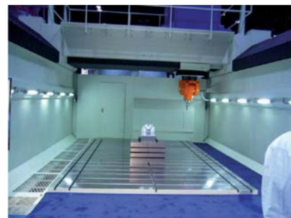
Obr. 1. Tchajwanská firma APEC (Asia Pacific Elite Corporation) představila větší portálový pěti osý stroj Dynamic Speed APEC 2750 s rozměry stolu 5,3 x 3m. Stroj je na všech pravouhlych pohybových osách vybaven lineárními motory. Dosahované posuvové rychlosti jsou 50 m/min.
