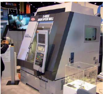
Obr. 11. Stroj Zu3500 firmy NTC určený pro mikroobrábění. Všechna vedení jsou bezkontaktní hydrostatická, pohony realizovány lineárními motory, speciální krytování s minimalizací pasivních odporů.
