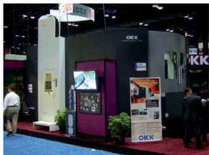
Obr. 5. Příklad velkého kompaktního „single-piece body“ horizontálního centra s integrovanou výměnou palet o velikosti 1 250 mm od firmy OKK.
