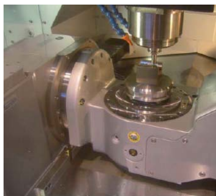
Obr. 12 a 13. Špičkové pětiosé frézovací centrum HS650Linear pro obrábění v submikronových přesnostech od firmy SODICK. nanoobrábění s pěti souvisle řízenými osami. Stroje pro mikroobrábění a nanoobrábění charakterizují především dosahované přesnosti a tolerance na mikronové a nano úrovni, nikoli však nutně miniaturní rozměry
