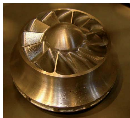
Obr. 23. Prezentace komplexních schopností firmy pomocí velmi náročného obrobku. Jedná se o oběžné kolo s uzavřenými kanály, které je třeba obrábět pouze vstupy ze dvou otvorů. Obrobenej plochy jsou perfektně napažené, přestože k jejich obrábění docházelo z různých stran a nepřístupným prostorem.
