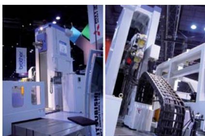
Obr. 3. Společnost Mitsubishi Heavy Industries prezentovala svůj horizontální stroj M-HT13/1618 s parametry Y=2\,500\text{mm} a Z=1\,300\text{mm} . Zajímavé je provedení bohatě ručicově žebrovaného stojanu, zkosného výrazně ve směru osy Z.
