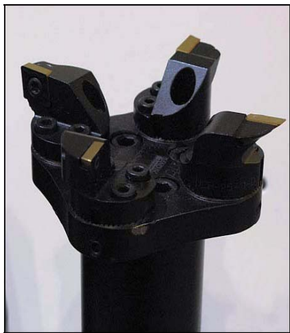
Obr. 39. Multitasking nástroj je upnut ve frézovací vřetenu a slouží pro soustružení. Při přetočení vřetena o 90° a zablokování je připravena pro soustružení jiná řezná destička. Multitasking nástroje mohou obsahovat na každé pozici zcela odlišnou destičku.
