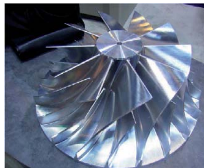
Obr. 24. Příklad obrobku oběžného kola tlakového stroje s dokonalým povrchem lopatek bez přidavné operace leštění a vyhlazování. Každému, kdo realizoval takovýto obrobek, je zřejmé, že dosažení takového výsledku předpokládá technickou a technologickou zdatnost firmy na vysoké úrovni.
