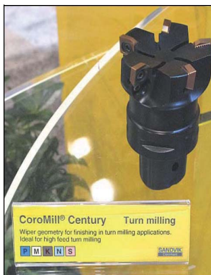
Obr. 40. Nástroje určené pro frézování i soustružení. Tzv. TurnMill nástroje umožňují frézování a v zablokovaném stavu vřetena pak soustružení.
