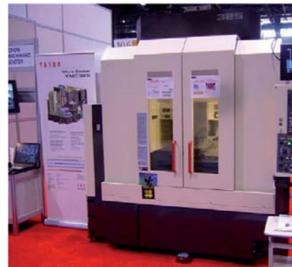
Obr. 17. YASDA představila inovovaný stroj YMC325, vynikající především špičkovou teplotní stabilizací s komplexně protékáním rámem. Stroj je vybaven hydrostatickým vedením na všech osách, lineárními motory a vřetenem s max. otáčkami 60tis./min.
