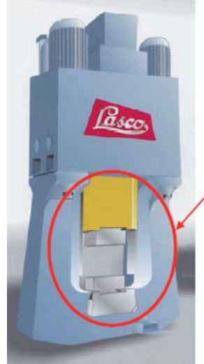
Obr. 8. Buchar firmy LASCOS – vyznačená oblast teplotně ovlivněná tvářeným polotovarem
