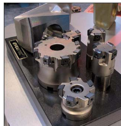
Obr. 36. Příklady stále se více rozšiřujících frézovacích nástrojů s tangenciálními destičkami.
