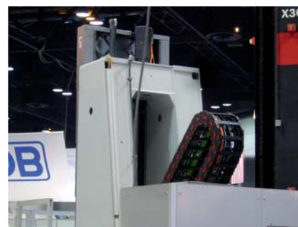
Obr. 2. Velkou pozornost věnovala firma MAG Giddling & Lewis strojům řady VTC (Vertical Turning Centers). Jedná se o plně kapotované stroje s karuselovacími stoly od průměru 1 000 do 3 500mm. Na obrázku je zachycena vrchní část zkoseného ocelového svařovaného stojanu jednoho z horizontálních vyvrtávacích strojů.
