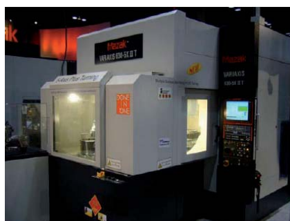
Obr. 34. Stroj Mazak VARIAXIS 630-5X II T je příkladem horizontálního pětiosého frézovacího centra s otočným stolem umožňujícím karuselovat při otáčkách až 1 100 min -1 . Vpravo je pohled na detail otočného stolu umožňujícího plnohodnotně konturovat i soustružit.
