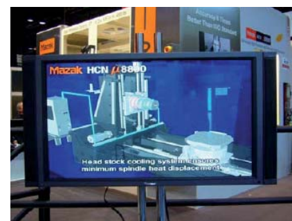
Obr. 8. a 9. Nové horizontální centrum Mazak HCN u8800. Stroj je podřízen nejen nárokům na vysokou produktivitu, ale také na vysokou přesnost – Mazak deklaruje vlastnosti jako High speed and ultra high accuracy. Přesností je podřízena konstrukce s tím, že je aktivně chlazeno lože, stojan, všechny pohony a přirozeně i vřetenlo.
