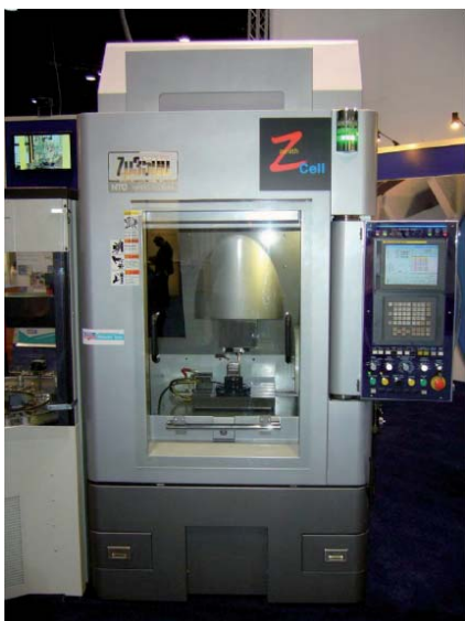
Obr. 11. Stroj Zu3500 firmy NTC určený pro mikroobrábění. Všechna vedení jsou bezkontaktní hydrostatická, pohony realizovány lineárními motory, speciální krytování s minimalizací pasivních odporů.
