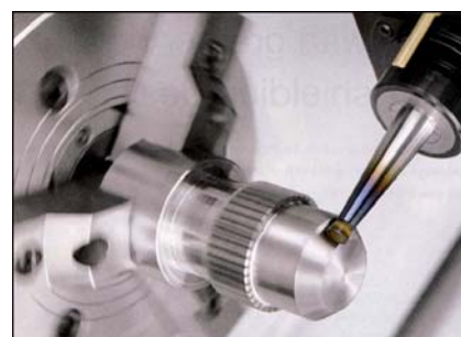
Obr. 37. Nástroj je upnut ve frézovacím vřetenu a s nízkými otáčkami se otáčí, čímž se dostává do řezu nové ostří. Společnost MORI SEIKI prezentuje až 10násobné zvýšení životnosti nástroje oproti konvenčnímu provedení soustružnického nože s pevně uloženou destičkou.
