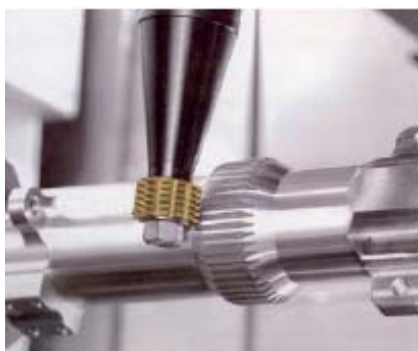
Obr. 14. Drážkování, popř. výroba ozubení prováděná na soustružnicko-frézovacím
