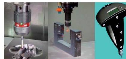
Obr. 28. Příklady měřících technik pro měření obrobku a nástroje přímo v pracovním prostoru stroje - A
