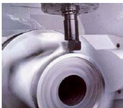
Obr. 15. Plnohodnotné soustružení na frézovacím stroji
