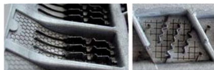
Obr. 11. Destičky z uhlíkových kompozitů texturované laserem.
