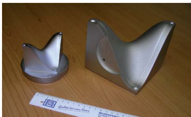
Obr. 12. Artefakt pro měření pracovní přesnosti souřadnicových měřících přístrojů
