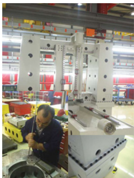
K přesnosti strojů přispívá i ruční škrabání důležitých ploch, které v průměru zabere 500 pracovních hodin na jeden stroj.
