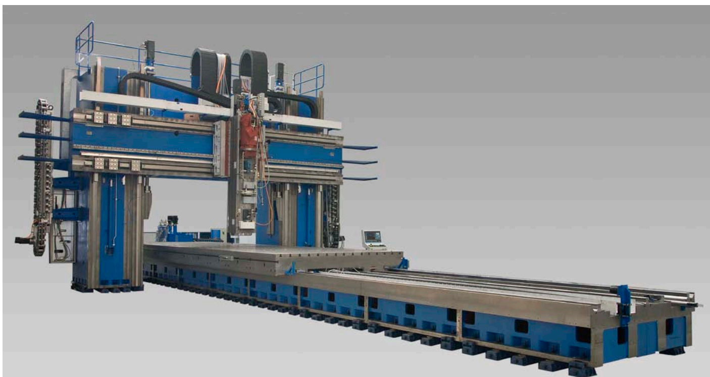
Portálové obráběcí centrum s přesuvným příčnίκem FRPQ 300 –FTVR/A10 při montáži.
