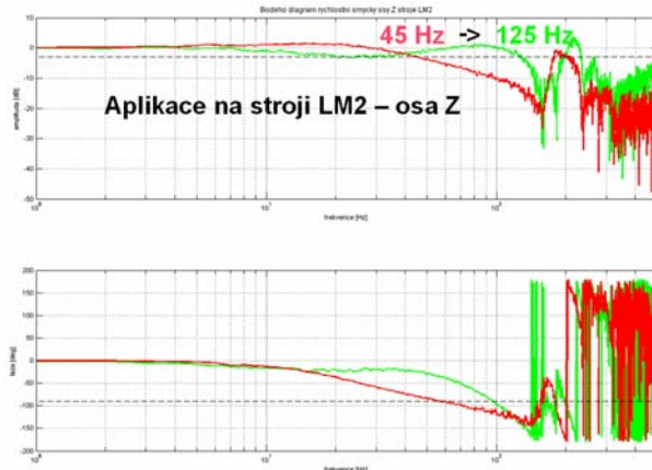
Obr. 9: Aplikace kompenzace dynamického chování na osu Z experimentálního obráběcího stroje LM2 (VCSVT). Vynesena jsou propustná pásma rychlostní smyčky bez kompenzace (červeně) a s kompenzací dynamického chování (zeleně). Kompenzovaný systém dosahuje několikanásobně vyššího propustného pásma.
