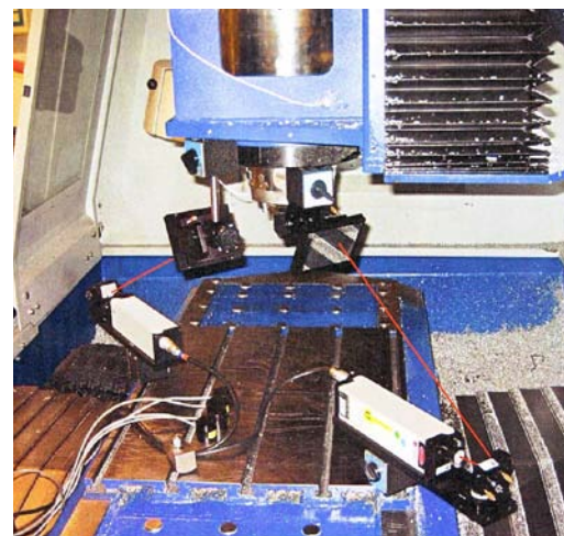
Systém optodyne orientuje laserové paprsky diagonálně pro jeho sekvenční krokový diagonální měřicí systém.
