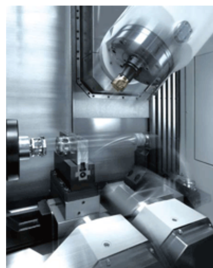
Pracovní prostor vícefunkčního stroje fy. Mazak.
