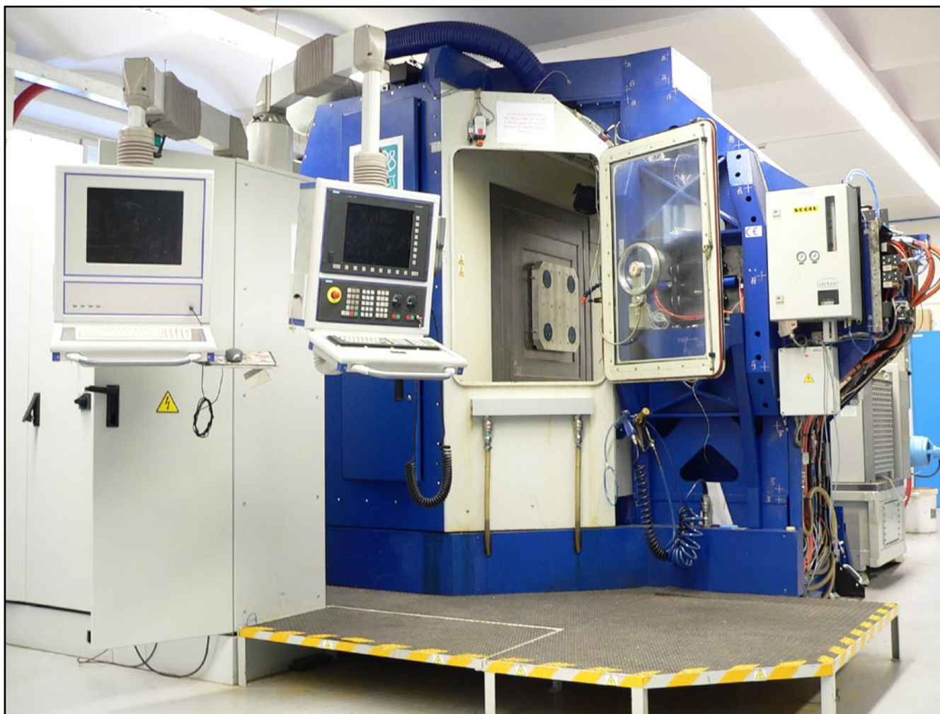
Obr. 3: Experimentální stroj LM-2 s vysoce dynamickými parametry řízených os
