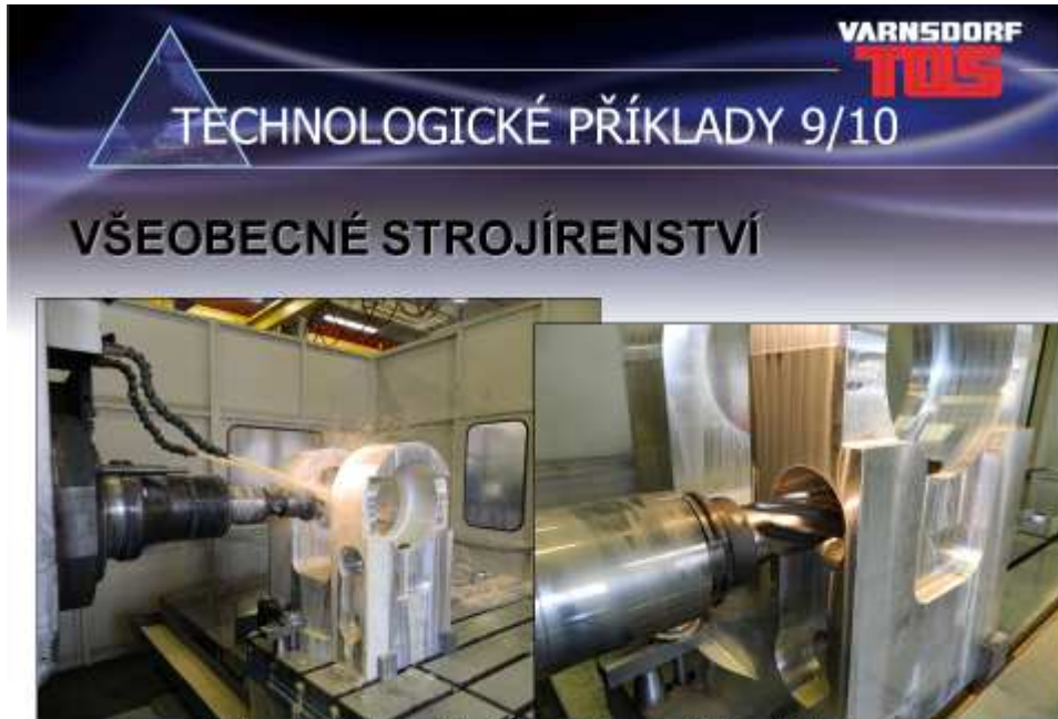
Frézování hliníkového tělesa frézovací hlavy HV/2
