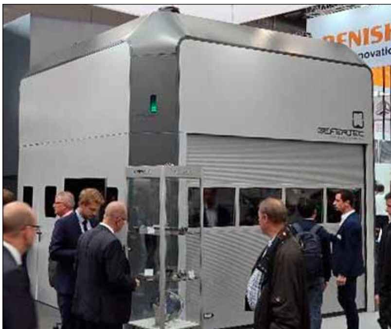
Obr. 3: Nový navařovací stroj firmy GEFERTEC který navařuje díly z kovu pomocí elektrického oblouku (bez obrábění).
