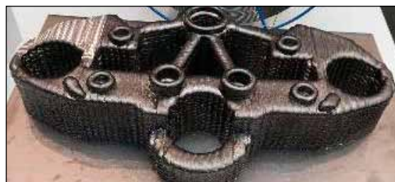
Obr. 3: Nový navařovací stroj firmy GEFERTEC který navařuje díly z kovu pomocí elektrického oblouku (bez obrábění).
