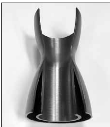
Dvouplášťový tenkostěnný dílec v řezu, materiál Konstrukční ocel, hmotnost 115 kg, rychlost výroby 300 g/hod.
