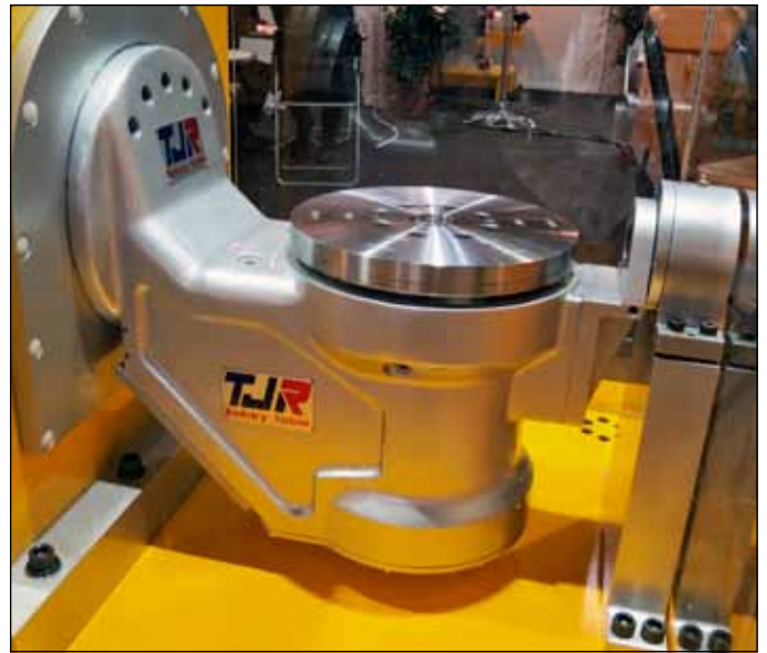
Nabídka stolů pro frézování i soustružení s prstencovým motorem a s maximálně 2500 ot/min.
