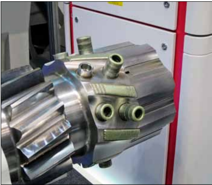
Návar Inconelu na nerezovou ocel provedený na stroji WFL
