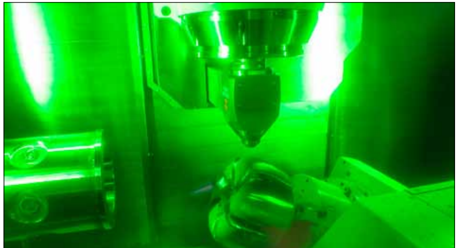
Pracovní prostor Mazak s laserovou navařovací hlavou
