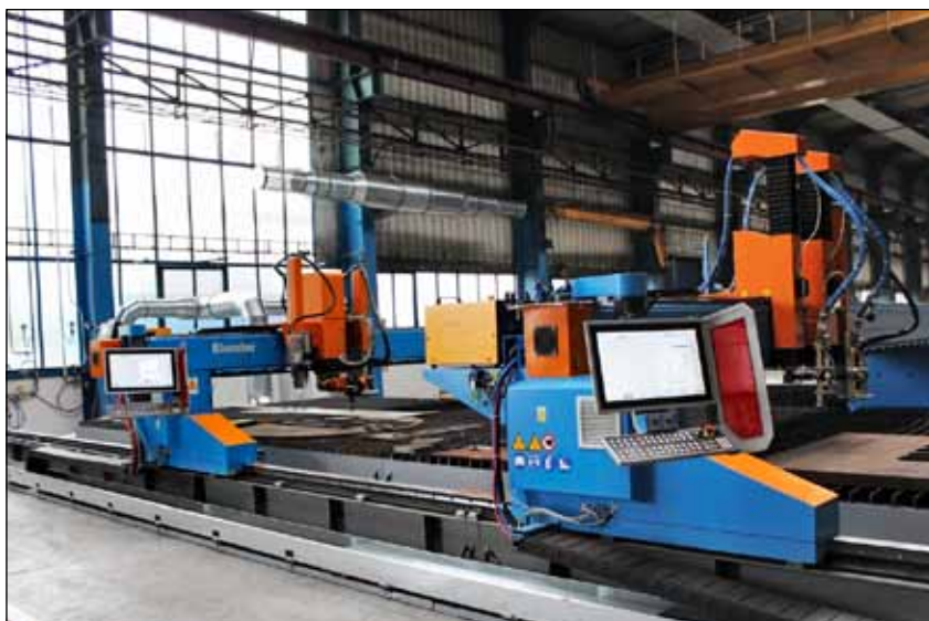
Dvouportálový stroj Bluester 45 na 120 s 3D technologií
